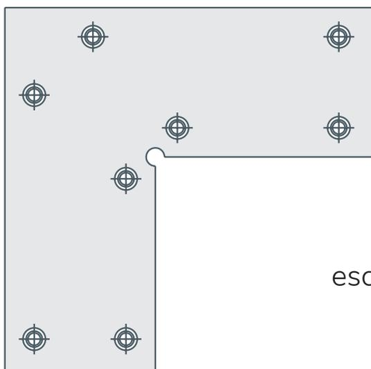
Para evitar deformaciones, utilice una escuadra reforzada en "L", el perfil debe ser igual o superior a 45 mm
