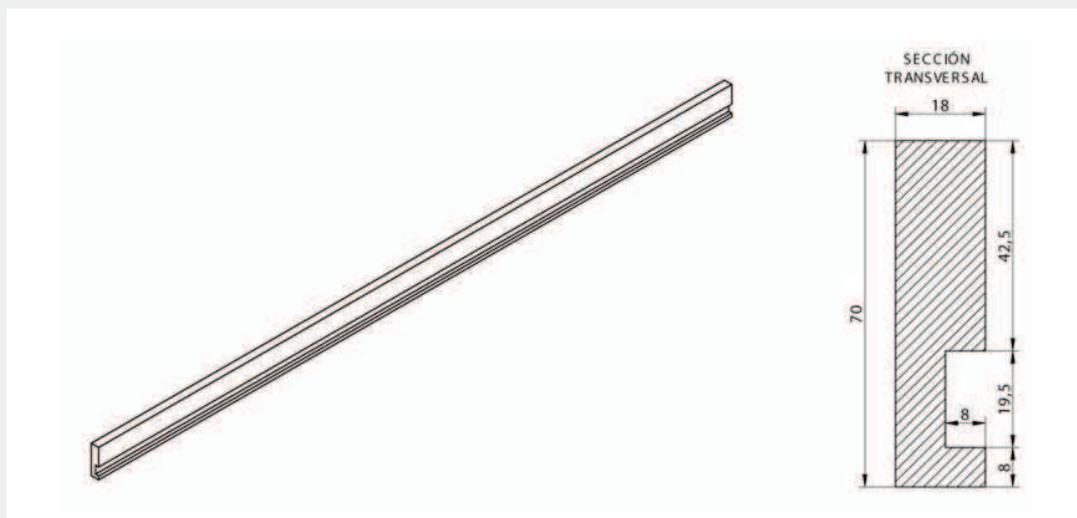
Cada marco frontal va acompañado de un ajuste de 150 mm que será el usado para cortar en obra y llevar a medida. Los ajustes se sujetan al marco mediante tornillos por su parte posterior. El ajuste de 150 mm se corta dependiendo el espacio a cubrir y el corte se esconde detrás del marco frontal.
